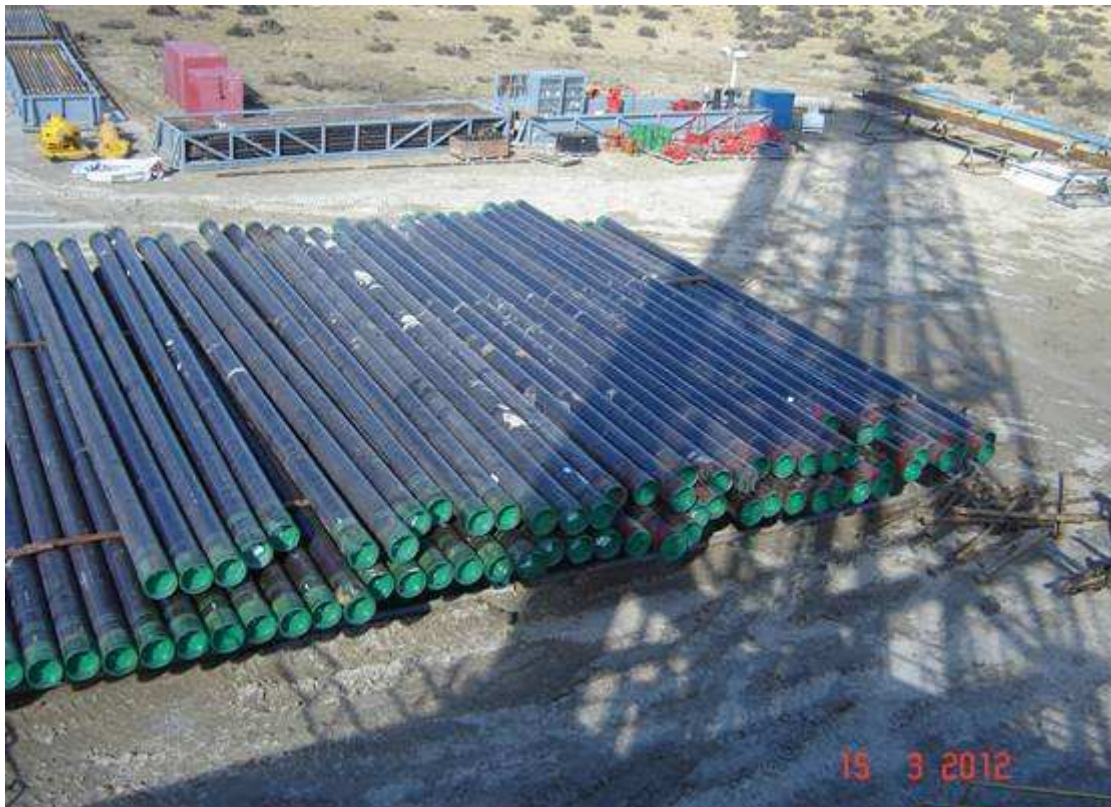
Tubería lista para ser bajada al pozo.
